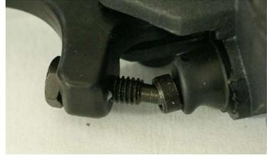
レバー遊び調整方法・・・指が届かないなどの理由で遊びを多くしたい場合は左写真のように、つながるポイントを先のほうにしたい場合は右写真のように。 限界点はリザーバータンクのフタを外しレバーを握ったときに勢い良く液が飛び出せばOKです。飛び出さない場合は調整ネジの締めすぎで 温度変化で遊びが変化してしまい油圧の利点 自動調整が機能せず最悪破損します。
