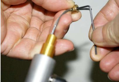
タイコの位置調整中 真ん中に有るホローセットボルトでワイヤーに固定します、締め込みが弱いと使用中に緩んで非常に危険です。
