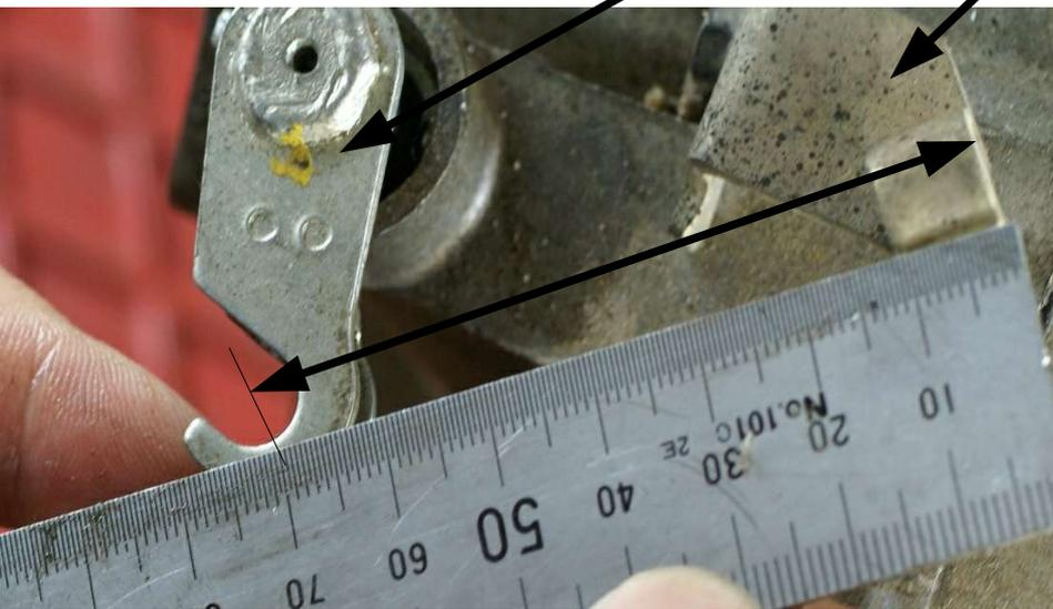
次に、軽く押したリリースレバーのタイコが入る溝中心とノーマルのワイヤーホルダーステー後ろ端の長さを測定
